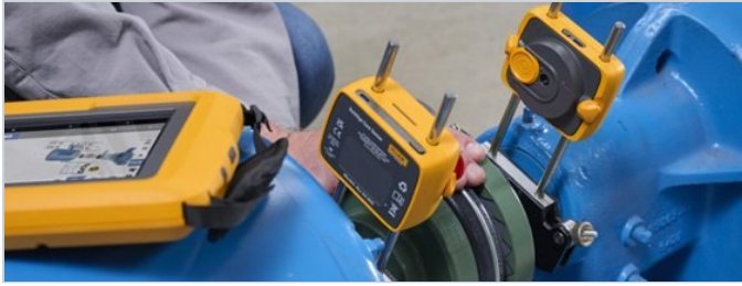
모터-펌프 커플링에 설치
