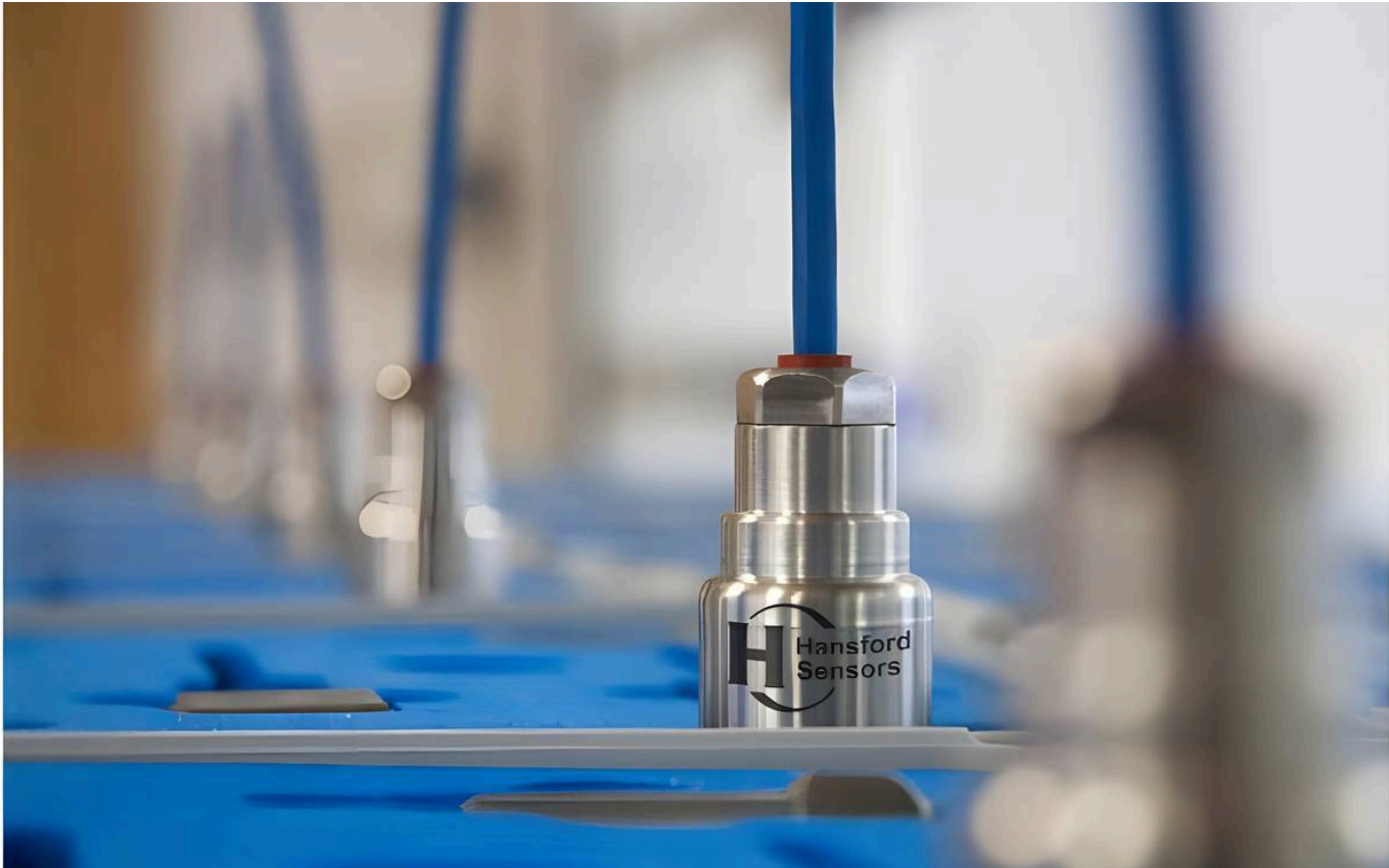
외관 균열, 체결 상태, 커넥터 접촉 · 침수, 케이블 꺾임을 정기적으로 확인합니다. 필요하면 제조사 교정을 받습니다.
