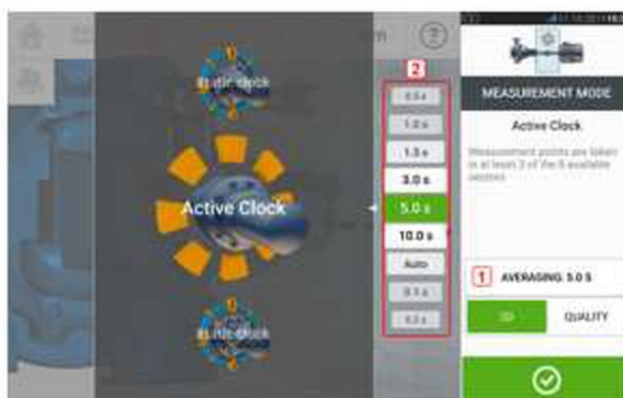
그림 13. Active Clock 측정 화면과 평균 횟수 설정 (출처 SHAFTALIGN Touch Pocket Guide)
