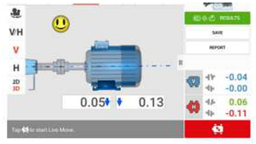
그림 16. 공차 안에 들어온 결과 (출처 SHAFTALIGN Touch Pocket Guide)
