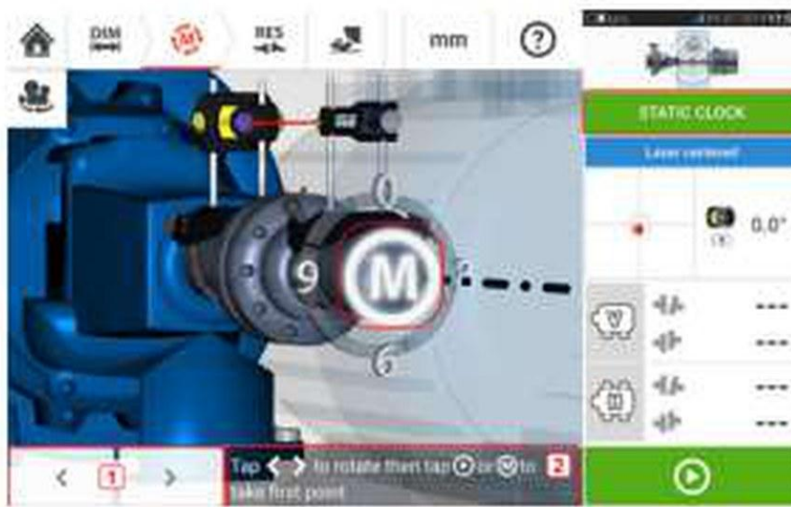
그림 14. 정적 측정 화면 (출처 SHAFTALIGN Touch Pocket Guide)
