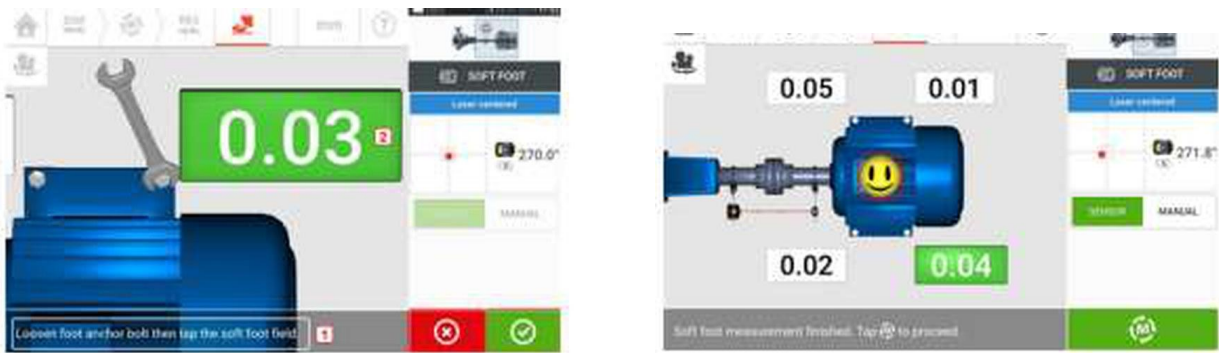
그림 18. 발 하나의 볼트를 푼 뒤 값 확인(왼쪽) · 네 발 측정을 마친 화면(오른쪽) (출처 SHAFTALIGN Touch Pocket Guide)
