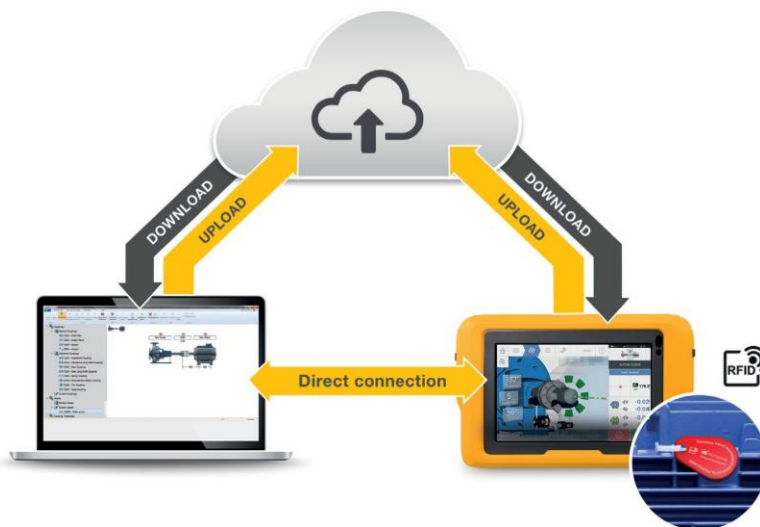
그림 20. 태블릿과 ARC 4.0 사이 측정 데이터 송수신 (출처 ShaftAlign Touch Technical Data)
