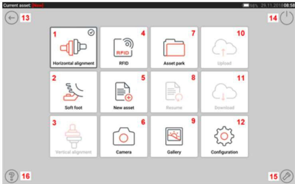
그림 6. 정렬 앱 홈 화면 (출처 SHAFTALIGN Touch Pocket Guide)
