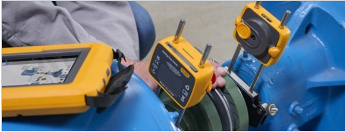
모터-펌프 커플링에 설치
