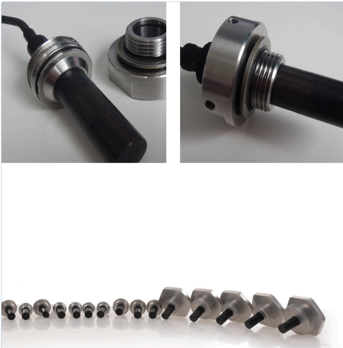
어댑터를 따로 둔 센서 헤드(위 왼쪽), 어댑터를 끼운 센서 헤드(위 오른쪽), 나사 어댑터 종류(아래) (출처 Gill 퀵스타트 가이드 Issue 4)
