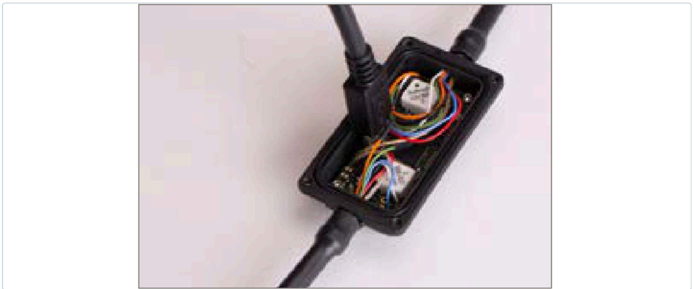
인라인형 전장부 덮개를 열고 마이크로 USB 단자에 연결한 모습 (출처 Gill 매뉴얼 Issue 7)
