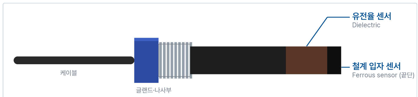
센서 헤드 구조. 끝단의 철계 입자 센서(Ferrous sensor)와 그 위의 유전율 센서(Dielectric) (Gill 매뉴얼 Issue 7 도식을 다시 그림)
